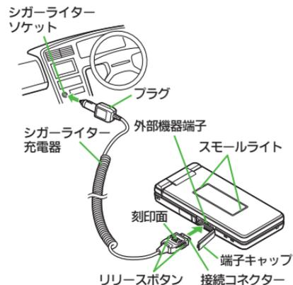
**1 外部機器端子の端子キャップを開く****2 シガーライター充電器の接続コネクタを本機に差し込む**
