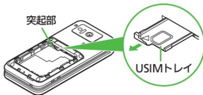
**3** 金色のIC部分を上にして、USIMカードをUSIMトレイにセットする
