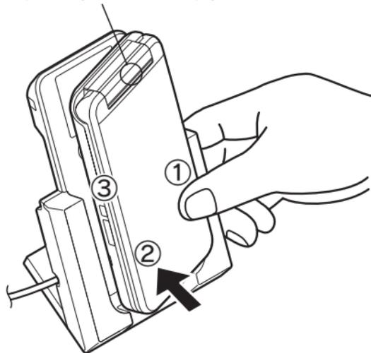
上図のように①の部分を支えながら、②の部分「カチッ」と音がするまで押し込む。
